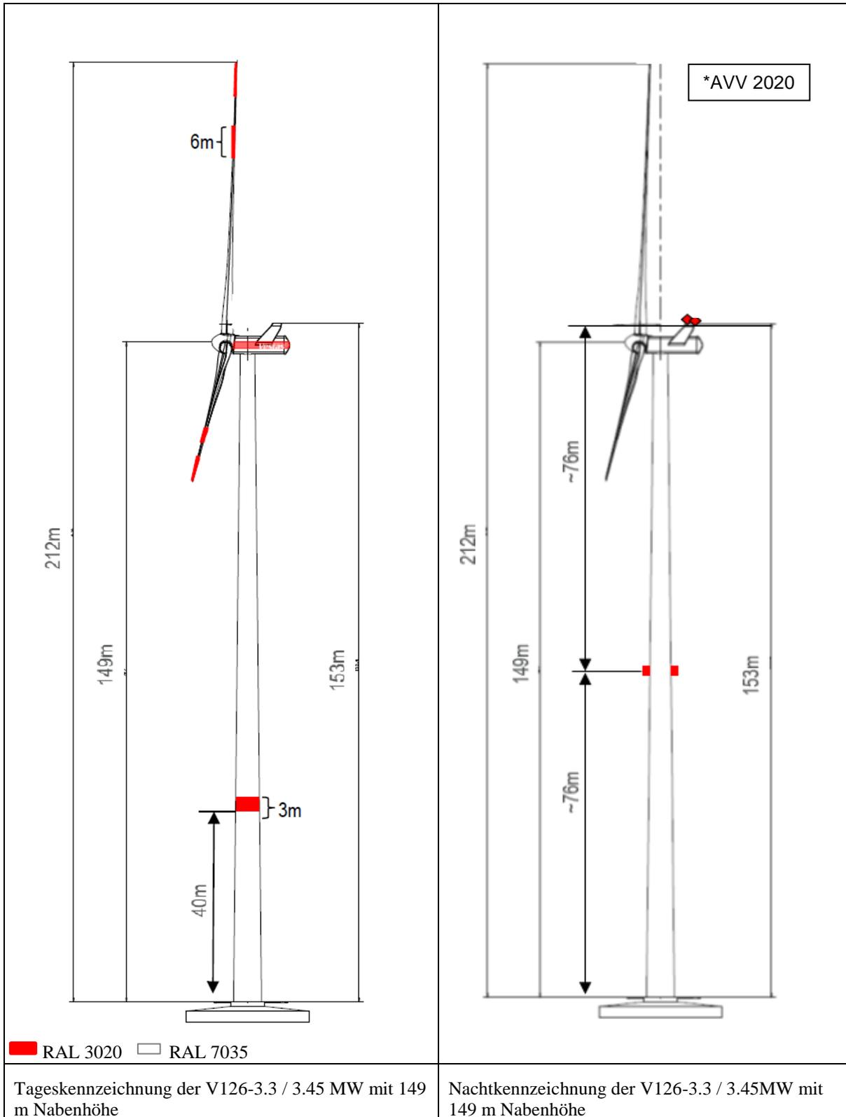
Tageskennzeichnung der V126-3.3 / 3.45 MW mit 149 m Nabenhöhe
